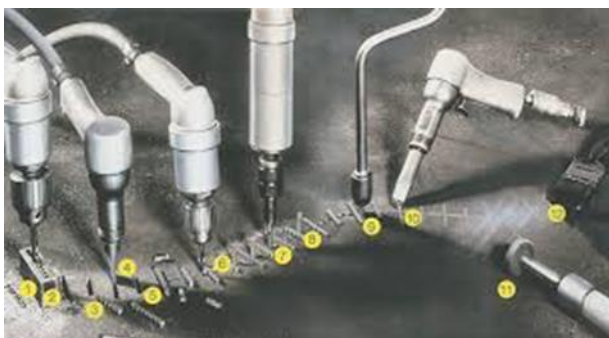
Figuur18. Repareren van gietijzer met behulp van krammen.
